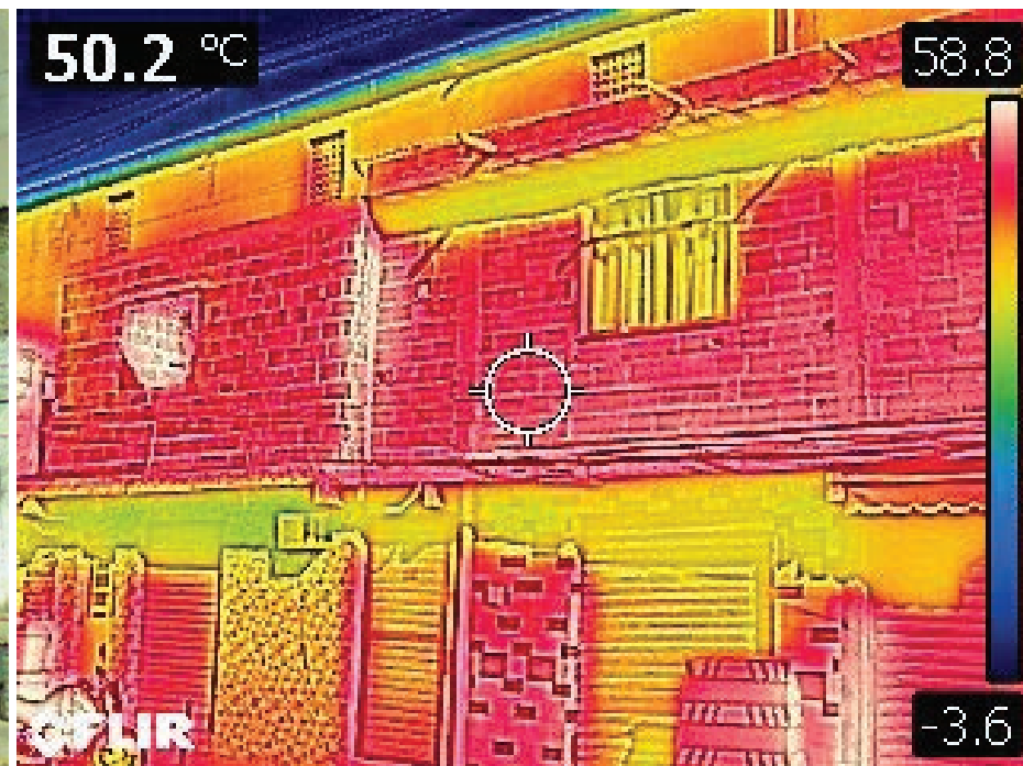
A fachada da casa, que não está pintada, passa dos 50 graus de temperatura como mostra a foto da pesquisadora feita por uma máquina especial
